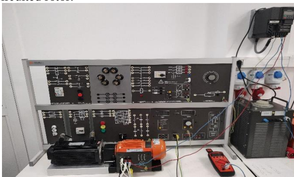
Fig.6 Stand de laborator pentru studiul masinii asincrone
